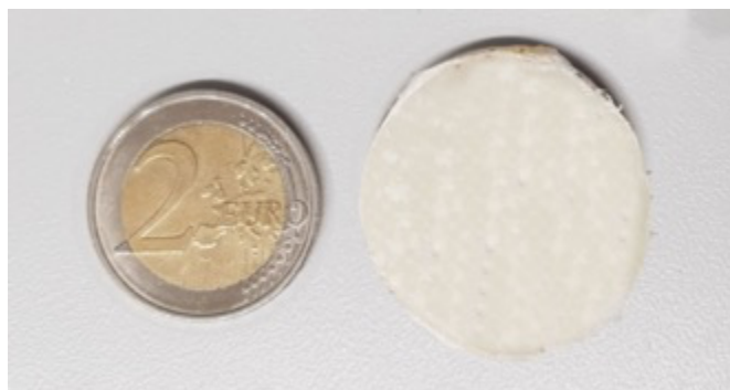
Abbildung: Probestück, vor Ort härtendes Schlauchlining.
