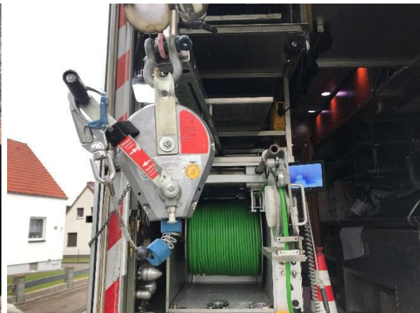
Bild 4: Winde zum Ablassen der Roboter & Material
