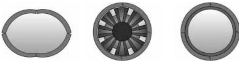
**Abbildung 2: Ausgleichen von Deformationen beim TIP-Verfahren**
