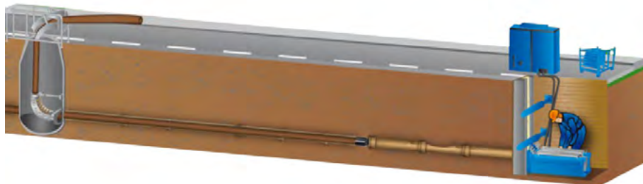
Abbildung 16: Rohrreinbau mit der Umformtechnik vom Startschacht zur Zielbaugrube
