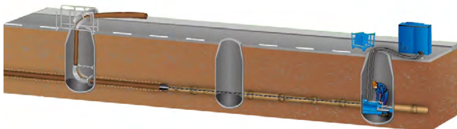
Abbildung 17: Rohrreinbau mit der Umformtechnik vom Startschacht zum Zielschacht
