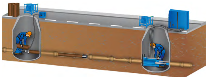
Abbildung 8: Einbau Einzelrohre Startschacht (l.) – Zielschacht (r.) (Einzugsverfahren)
