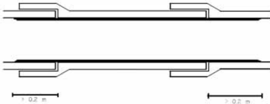
Abbildung 2: Reparatur von Längsrissen/Scherbenbildung
