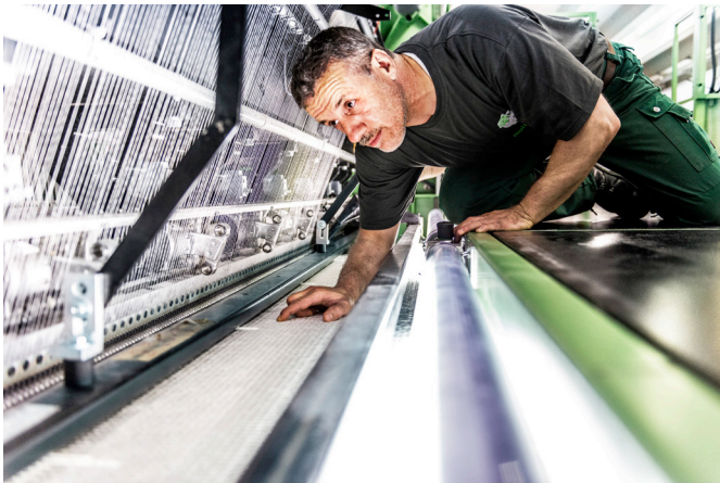
Abbildung 5: Herstellung eines Schlauchliner-Vorprodukts im Werk (Bild: SAERTEX multiCom GmbH)
