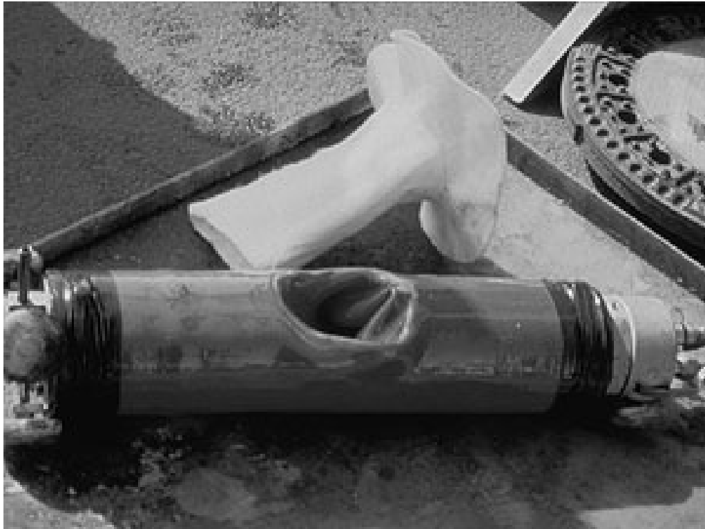
Bild 2: Hutprofilsetzgerät mit kombinierter Blase für Kreppe und Stutzen (Stutzen eingefahren)
