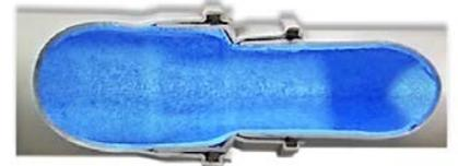
**Kurzliner:** Im Hausanschlussbereich werden oft Kurzliner eingesetzt, bei denen Gewebemanschetten aus Glasfaser mit einem Kunstharz imprägniert, in die Leitung eingebracht und vor Ort ausgehärtet werden. Die erwartete technische Nutzungsdauer liegt bei 15 Jahren, abhängig vom Altröhr.
