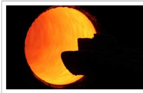
Moderne Gussrohrherstellung: Über eine Gießbrinne wird das flüssige Eisen in eine rotierende Kokille gegossen
