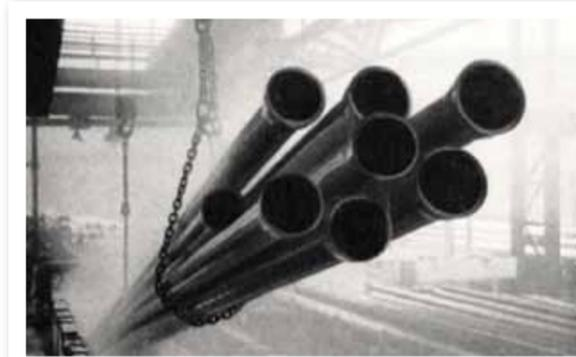
Frühe Art des Innenkorrosionsschutz: Tauchen von Stahlrohren in ein Bitumenbad
