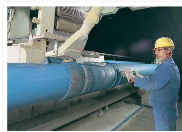
Herstellung einer Zementmörtelummantelung eines Stahlrohres für den Außenschutz im Werk
